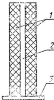
1 - звукопоглощающий материал; 2 - массивный материал (например листовая сталь толщиной 2 мм или дерево толщиной 25 мм); 3 - основание.
