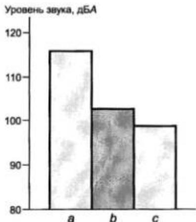
а - стальная пластина, толщиной 25 мм; б - стальная пластина, демпфированная слоем вязкого вибропоглощающего материала толщиной 40 мм; с - стальная пластина толщиной 200 мм
