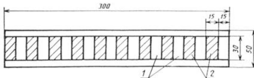
1 - площадь, через которую видна рабочая поверхность; 2 - образец из "Альбома колеров"
