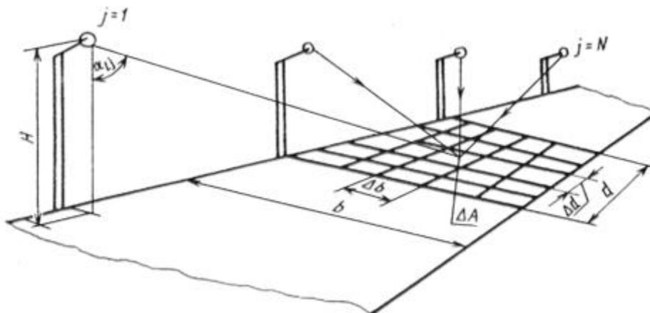
$d$  - длина контрольного участка;  $\Delta d$  - длина элементарной площадки;  $b$  - ширина проезжей части;  $\Delta b$  - ширина элементарной площадки;  $\Delta A$  - элементарная площадка;  $H$  - высота установки светильника;  $\alpha_{ij}$  - угол, ориентирующий направление силы света
