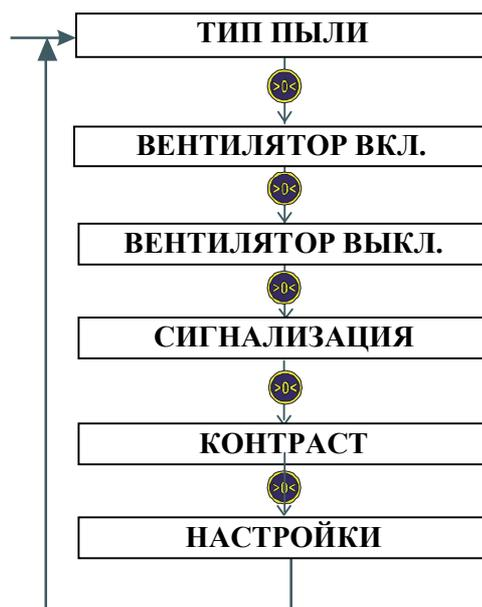
Рис. 5.5. Структура меню прибора АЭРОКОН-П
