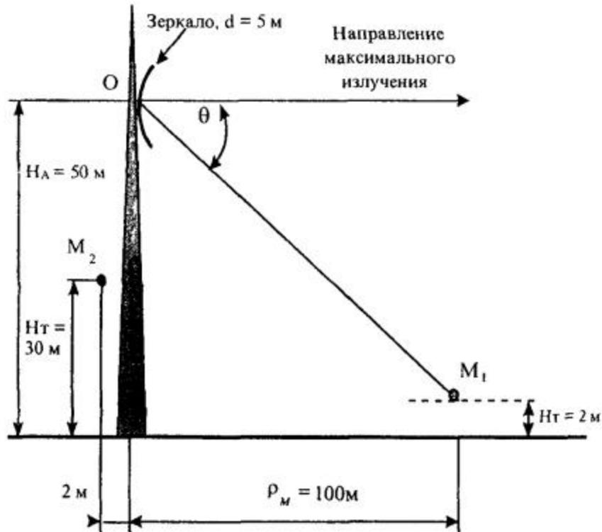
Рис. П2.1. Иллюстрация к примеру расчета ППЭ.
