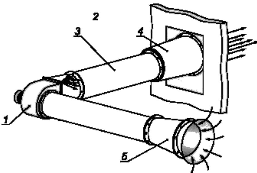
г) Компоновка типа Д: вход из всасывающего воздуховода, выход в нагнетательный воздуховод
