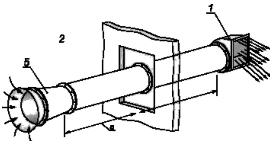
в) Компоновка типа С: вход из всасывающего воздуховода, свободный выход
