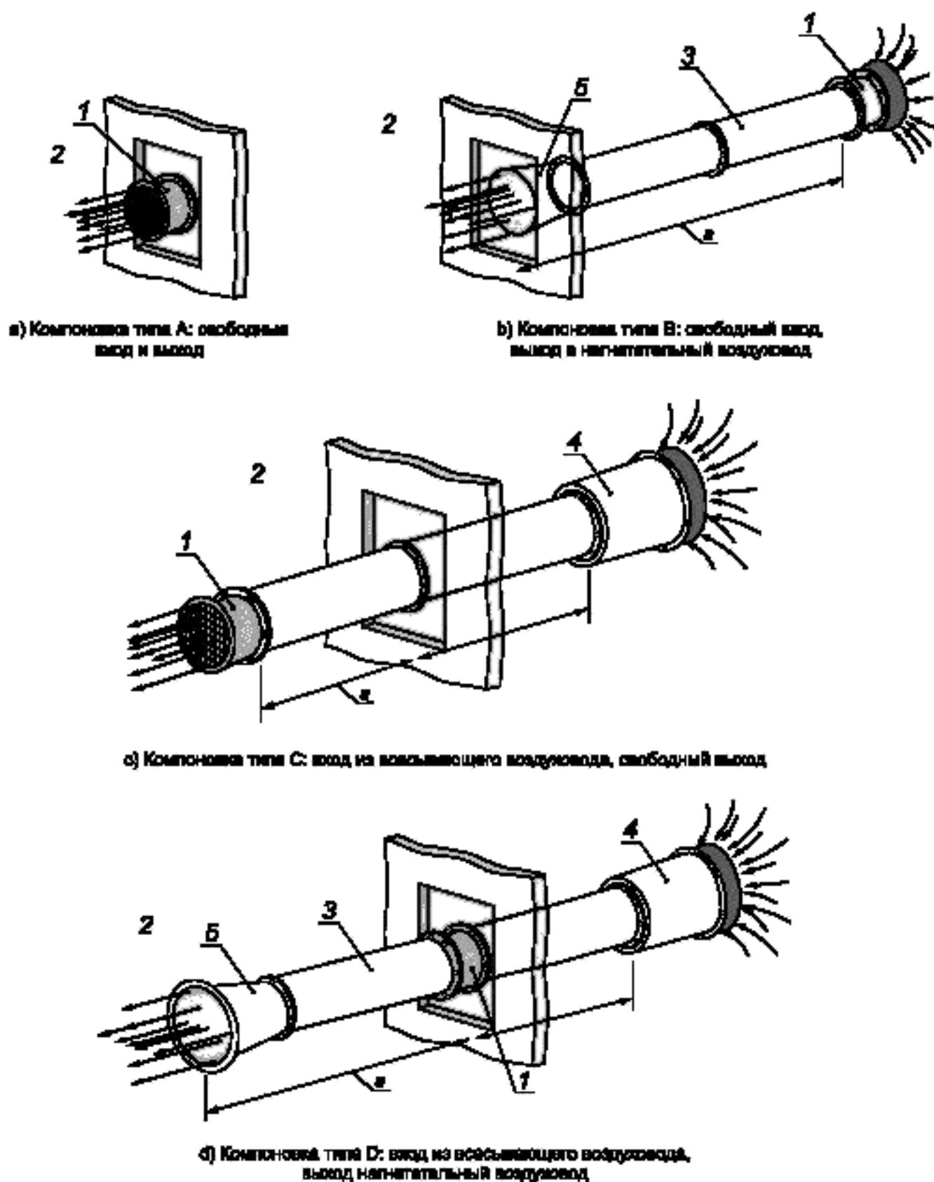
1 — вентилятор; 2 — пространство внутри реверберационного помещения (камеры); 3 — нагнетательный воздуховод; 4 — концевое поглощающее устройство упрощенной конструкции; 5 — акустический рупор, а — расстояние до стены
