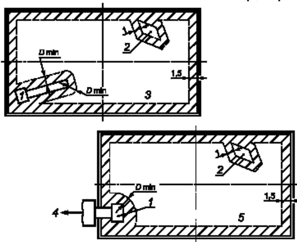
1 — вентилятор; 2 — рассеиватель звука, применяемый иногда, чтобы улучшить акустические характеристики испытательного помещения; 3 — помещение для испытаний по определению общей звуковой мощности; 4 — испытания на входе или выходе; 5 — испытательная камера или дополнительное помещение
