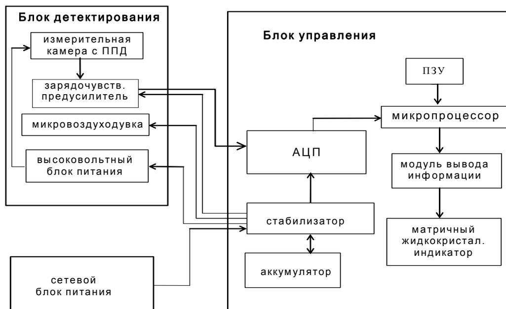
Рисунок 3. Функциональная схема радиометра.
