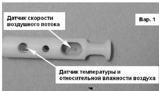
Рисунок 1. Расположение датчика скорости воздушного потока и датчика температуры и относительной влажности воздуха в сенсометрическом щупе измерителя МЕТЕОСКОП-М.
