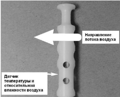
Рисунок 2. Расположение датчика температуры и относительной влажности воздуха относительно направления потока воздуха.
